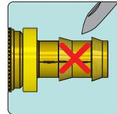
Zur leichteren Montage empfehlen wir den Schlauch E 2185 mit Hilfe von warmem Seifenwasser aufzustecken.
